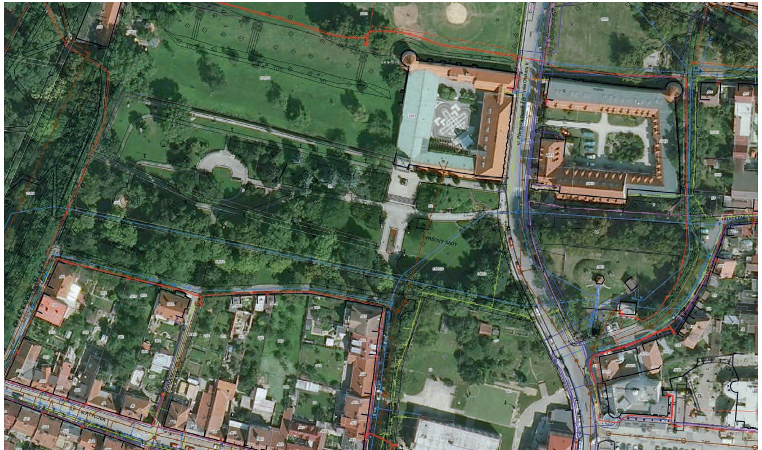
Výřez z digitální technické mapy s podtiskem leteckého snímku dokladuje zatížení řešeného území a dotčených území sítěmi technické infrastruktury.
